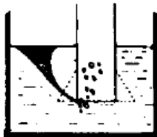
Fig. 5 - L'allargamento della tubazione di aspirazione normalmente previene i gorgi e la risultante entrata di aria nelle tubazioni.
