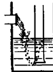
La linea di erogazione dovrebbe estendersi all'interno del pozzetto per prevenire l'agitazione dell'aria nell'acqua.
